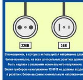
В помещениях, в которых используется напряжение двух и более номиналов, на всех штепсельных розетках должны быть надписи с указанием номинального напряжения. Выключи приборов на напряжение 12-50 В не должны входить в розетки с более высоким номинальным напряжением
