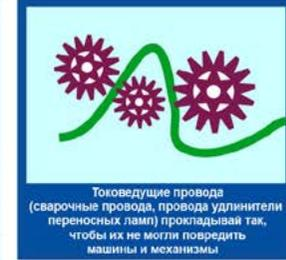
Токосоведущие провода (сварочные провода, провода удлинительных переносных ламп) прокладывать так, чтобы их не могли повредить машины и механизмы
