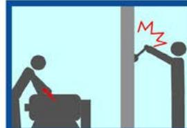
Появление напряжения на отключенных токоведущих частях во время ремонтных работ и осмотров (кто-то включил рубильник - подаст напряжение в сеть)
